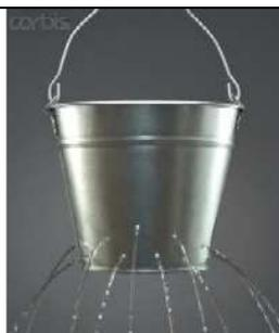
Pegue um balde e faça furos. Vai ver que na medida em que a água for acabando, a pressão exercida pela coluna de água vai diminuindo e a quantidade de água que sai pelos furos também vai diminuindo...
