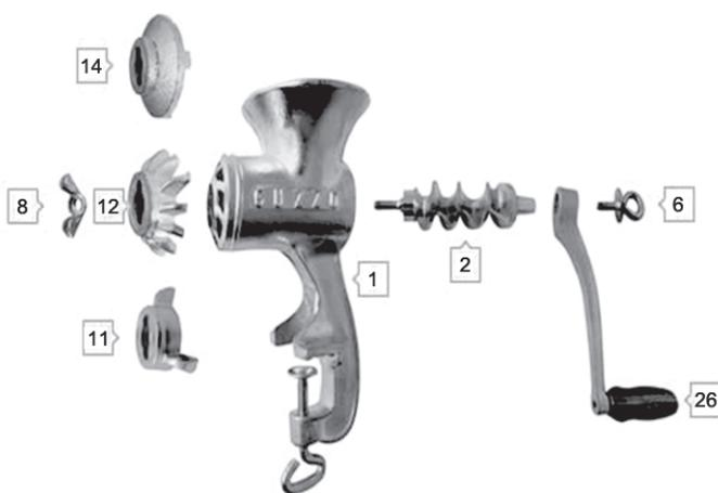
A figura representa peças que compõe uma máquina de moer manual, utilizada para o preparo de linguiça artesanal. Considerando-se que uma pessoa opera a máquina, girando a manivela (26) com uma frequência de 0,5Hz, e sabendo-se que
