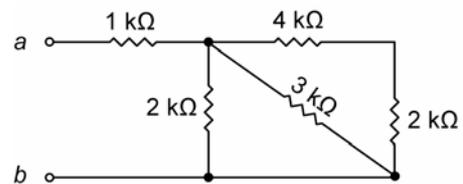
No circuito esquematizado na figura acima, a resistência equivalente medida entre os terminais  $a$  e  $b$  é de
