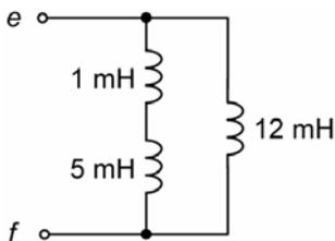
No circuito esquematizado na figura acima, a indutância equivalente entre os terminais  $e$  e  $f$  é de
