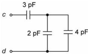
No circuito esquematizado na figura acima, a capacitância equivalente entre os terminais  $c$  e  $d$  é de
