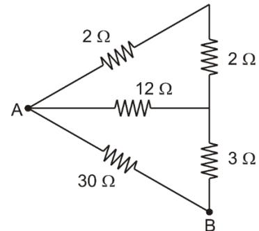
A resistência equivalente entre os terminais A e B é
