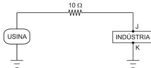
A linha de transmissão é percorrida por uma corrente elétrica de  $1,0 \cdot 10^3 \text{ A}$  de intensidade e voltagem nos terminais da indústria  $V_J - V_K = 1,1 \cdot 10^8 \text{ V}$ .
