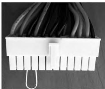
Um técnico da UFRR resolve então, com a fonte desconectada de todas as peças do computador, ligada somente ao cabo de alimentação de energia elétrica, inserir um clipe dobrado com uma das pontas no fio PS-ON de cor \_\_\_\_\_ e outra em um dos fios terra de cor \_\_\_\_\_:
