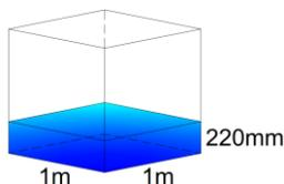
Com base nessas informações e desconsiderando eventuais perdas, um sistema de captação de água da chuva retangular (telhado), com dimensões de 10 metros de comprimento por 8 metros de largura, seria capaz de coletar a água da chuva no mês de janeiro de 2021, correspondente a um volume de:
