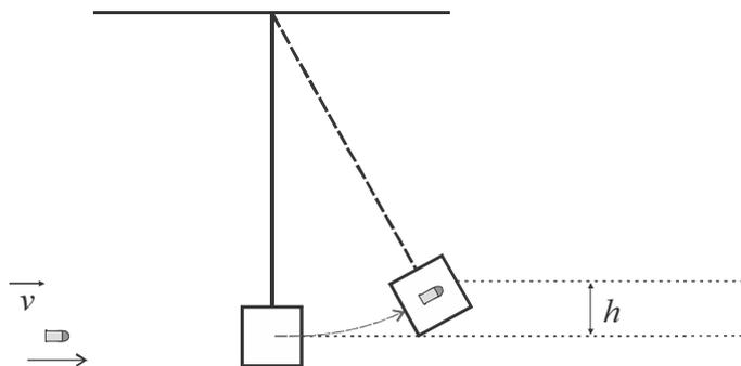
Uma bala de revólver de massa igual a 10 g foi disparada, com velocidade  $v$ , na direção de um bloco de massa igual a 4 kg, suspenso por um fio, conforme ilustrado na figura acima. A bala ficou encravada no bloco e o conjunto subiu até uma altura  $h$  igual a 30 cm.
