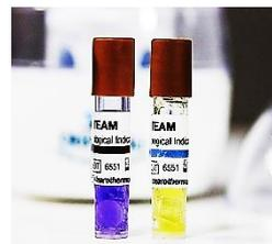
São testes que vêm em tubos plásticos com tampa permeável ao vapor, com uma fita impregnada com uma população conhecida de endósporos, separada do meio nutriente (líquido roxo) por uma ampola de vidro.
