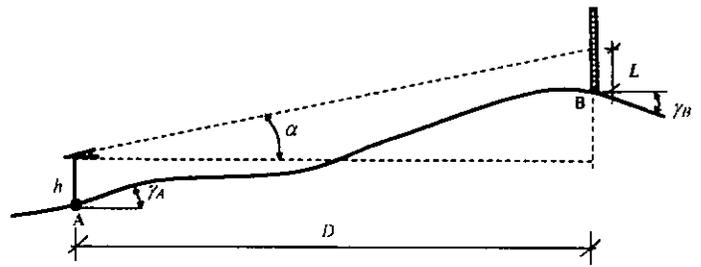
Deseja-se calcular a cota do ponto B, a partir de uma visada feita com o teodolito instalado no ponto A, cuja cota é conhecida. A alternativa que relaciona o conjunto de informações que são suficientes para se realizar esse cálculo é:
