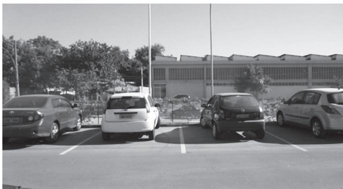
Observe acima uma área de estacionamento projetada recentemente para atender à edificação de uso público. Foi adotado, no desenho das vagas, o dimensionamento de 3,10 m x 5,00 m, atendendo, também, à legislação vigente, com relação ao número de vagas especiais necessárias. Analisando o dimensionamento proposto para as vagas comuns, verificou-se que o desenho final **NÃO** otimiza o número de carros estacionados porque
