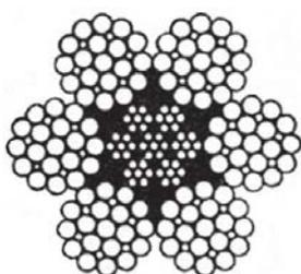
Um técnico de manutenção precisa substituir um cabo de aço cuja seção é apresentada na figura acima. Ao analisar sua seção transversal, o técnico classifica o cabo como de aço polido, solicitando ao almoxarifado 5 metros do cabo de diâmetro  $\frac{1}{2}$ " e alma de aço polido, com a seguinte descrição técnica:
