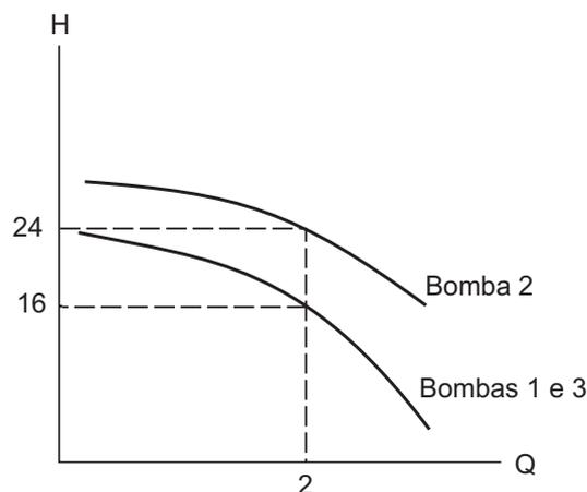
Três bombas associadas em série apresentam as curvas H x Q acima (H = altura manométrica total e Q = vazão). Desprezando a perda de carga, qual é, em unidades, a altura manométrica total do conjunto para a vazão indicada na figura acima?
