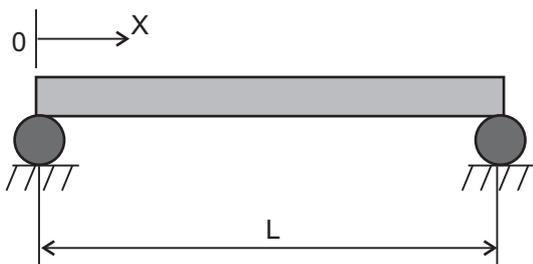
As cargas atuantes, formadas pelo peso próprio do tubo e o peso do fluido nele contido, são uniformemente distribuídas ao longo do comprimento do tubo. Desta forma, o maior momento fletor verificado no tubo está na posição  $x$  igual a
