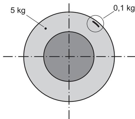
Durante o processo de balanceamento de uma roda de 5 kg, representada na figura acima, um técnico observou a necessidade de acrescentar uma pequena massa de 0,1 kg, distante 30 cm do centro da roda. Uma vez em operação, essa roda deverá girar a 30 rpm e a força de balanceamento devida a essa pequena massa será de
