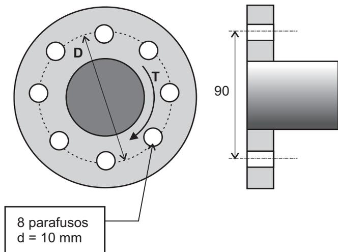
Um torque  $T$  igual a  $450 \cdot \pi$  N.m é transmitido de um eixo através de um flange conectado por oito parafusos de diâmetro igual a 10 mm. Sendo o diâmetro de posicionamento dos centros dos parafusos igual a 90 mm, o valor da tensão cisalhante nos parafusos, em MPa, é igual a
