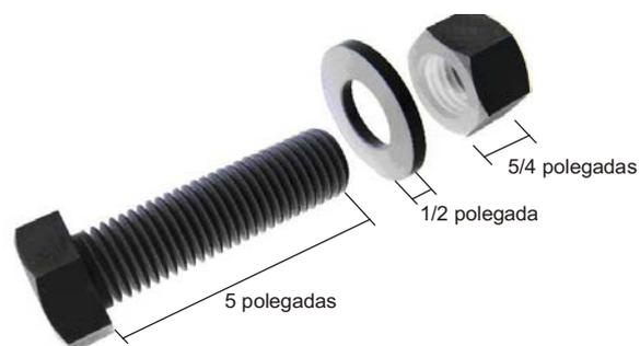
Se as duas peças indicadas mais à direita forem inteiramente parafusadas em sequência até a cabeça do parafuso, sobrar livre na rosca do parafuso o comprimento de
