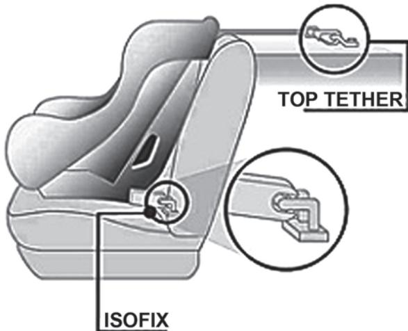
A cadeirinha do tipo Isofix não é presa no cinto, mas em dois pontos de apoio soldados à estrutura do carro. Há ainda um terceiro ponto, que pode ser de fixação superior (*top tether*), atrás do encosto. Cada garra de engate se encaixa num ponto de fixação. Depois, é só apertar o botão para soltá-lo.
