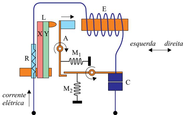
De forma similar,  $R$  e  $L$  são dimensionados para que esta última não toque a extremidade de  $A$  quando o circuito é percorrido por uma corrente até o valor nominal do disjuntor. Acima desta, o aquecimento leva o bimetal a tocar o atuador  $A$ , interrompendo o circuito de forma idêntica à do eletroímã.
