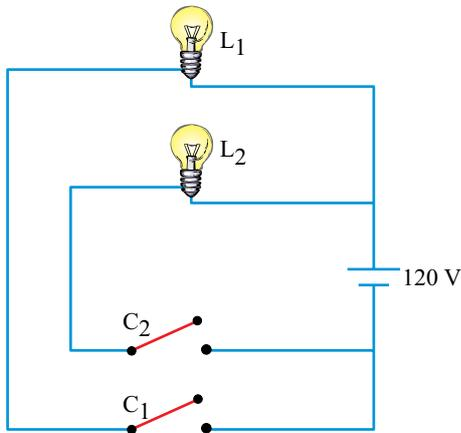
Com a chave  $C_1$  fechada e  $C_2$  aberta, o circuito dissipa 100 W. Com a chave  $C_1$  aberta e  $C_2$  fechada, dissipa 60 W. Se as duas chaves forem fechadas simultaneamente, o circuito dissipará, em W, uma potência igual a
