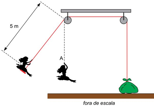
Desprezando a resistência do ar e a massa do assento, considerando  $g = 10 \text{ m/s}^2$  e as informações contidas na figura, a maior velocidade, em m/s, com a qual a garota pode passar pelo ponto A sem que o saco de areia perca contato com o solo é igual a
