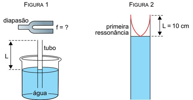
Considerando a velocidade de propagação do som no ar igual a 340 m/s, é correto afirmar que a frequência de vibração do diapasão, em Hz, é igual a
