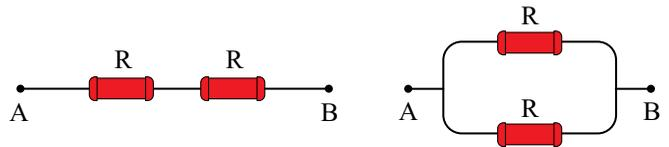
Considere que todo calor dissipado pelos resistores seja absorvido pela água e que, se os resistores forem associados em série, o aquecimento pretendido será conseguido em 1 minuto. Dessa forma, se for utilizada a associação em paralelo, o mesmo aquecimento será conseguido num intervalo de tempo, em segundos, igual a
