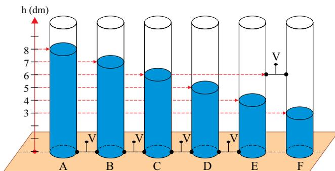
Com as válvulas (V) fechadas, cada reservatório contém água até o nível (h) indicado na figura. Todas as válvulas são, então, abertas, o que permite a passagem livre da água entre os reservatórios, até que se estabeleça o equilíbrio hidrostático.
