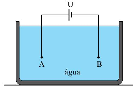
Para isso, dois resistores ôhmicos de mesma resistência  $R$  podem ser associados e ligados aos pontos A e B. Uma ddp constante  $U$ , criada por um gerador ideal entre os pontos A e B, é a mesma para ambas as associações dos resistores, em série ou em paralelo.
