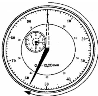
Considerando que o mecânico foi escalado para medir e registrar as possíveis não conformidades nas medidas dos componentes mecânicos inspecionados, e a respeito dos relógios comparadores, julgue os itens subsequentes.
