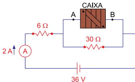
O estudante observa que, quando o circuito está em funcionamento, o amperímetro indica 2 A. Considerando essas informações, a resistência equivalente dos resistores associados dentro da caixa é igual a
