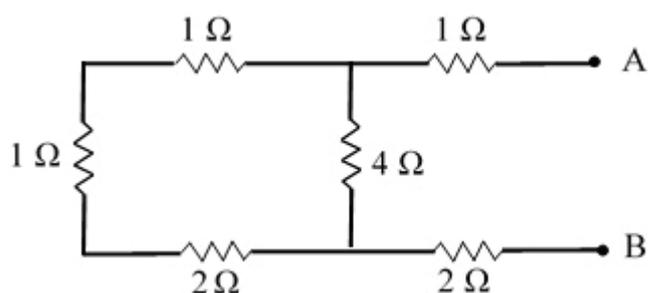
A corrente elétrica que atravessa o resistor de  $4 \Omega$  tem intensidade, em ampères, de:
