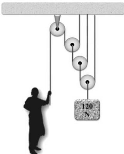
A figura acima ilustra a situação em que um homem exerce uma força no fio para manter um corpo de 120 N em equilíbrio estático, por meio de um sistema de roldanas. Os fios são inextensíveis e têm massas desprezíveis. As polias são ideais, isto é, não têm peso e não há atrito entre elas e os fios.
