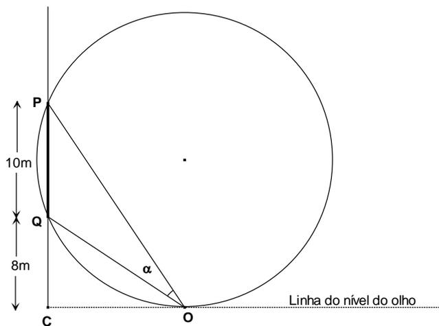
Imagine uma circunferência passando pelo olho O do observador e por dois pontos P e Q, verticalmente dispostos nas bordas superior e inferior do mural. O ângulo  $\alpha$  será máximo quando esta circunferência for tangente à linha do nível do olho, que é perpendicular à parede onde se encontra o mural, como mostra a figura. Com estas informações, calcule a que distância OC da parede deve ficar o observador para ter a melhor visão do mural de Joan Miró e apresente o resultado no cartão-resposta.
