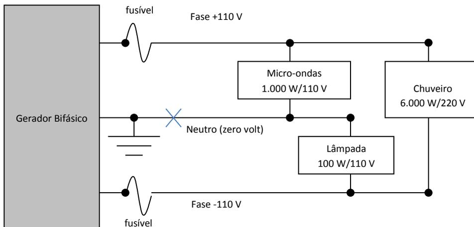
Nesse tipo de circuito, o rompimento do fio neutro provoca alteração de tensão fornecida a alguns aparelhos, podendo levar à queima deles. Nesse caso, se o fio neutro romper-se, no ponto indicado na figura por um X, é correto afirmar que apenas
