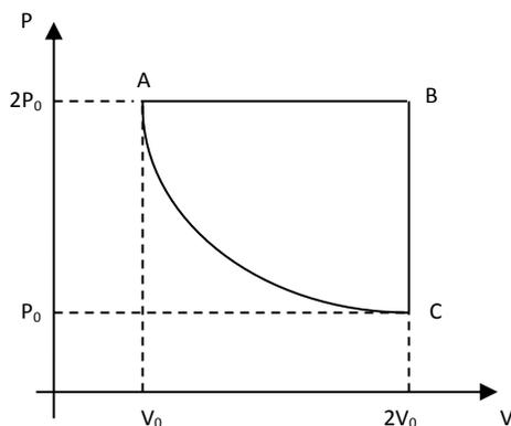
No estado representado em A, o sistema sofre uma expansão isobárica para o estado B. Em seguida, a pressão é reduzida, com volume constante, para o estado C. Por fim, o gás é comprimido, à temperatura constante, de volta para o estado A. Assim, em um ciclo completo, entra no sistema uma quantidade de calor correspondente a
