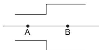
Um fluido incompressível de densidade igual a 0,8 escoou em regime permanente pelo conduto ilustrado na figura acima, na qual a velocidade no ponto A é de 2 m/s e a velocidade no ponto B é de 1 m/s. Sabendo-se que a perda de carga é de 0,4 mH<sub>2</sub>O e que a pressão no ponto A é de 5 mH<sub>2</sub>O, qual é a pressão no ponto B?
