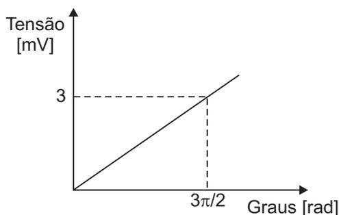
O gráfico acima apresenta a curva de calibração de um instrumento para medição de deslocamento angular. Considerando-se que esse instrumento apresente comportamento linear, o ângulo de rotação necessário para que a leitura do instrumento seja de 1 mV corresponde a
