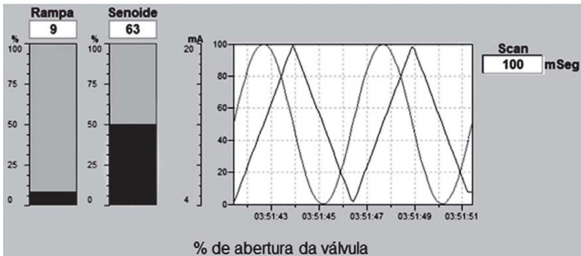
A figura acima representa uma pequena parte de um sistema supervisório no qual são apresentados gráficos e valores de abertura e fechamento de duas válvulas (rampa e senoide). Utilizando essa figura, analise as afirmativas abaixo.
