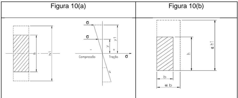
Para a mesma rotação da viga, a altura maior sofre maior deformação ( $\sigma = E \times \varepsilon$ ) e, portanto, produz maior tensão. Dadas essas considerações, para a Figura 10(b) determine  $\alpha$  em função de  $n$ .
