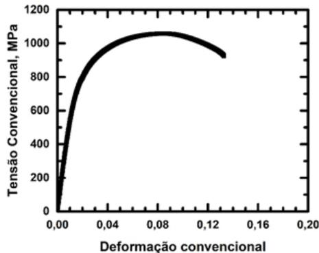
Quais os valores da tensão de escoamento, do limite de resistência, da deformação verdadeira no ponto de carga máxima, coeficiente de resistência, coeficiente de encruamento, e carga máxima sabendo que:
