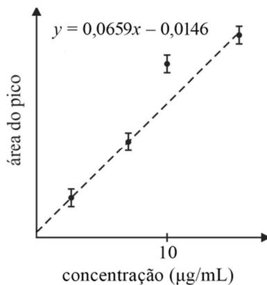
Para a validação de um método analítico por cromatografia líquida de alta eficiência, foi obtida a curva analítica mostrada na figura acima. Com base nessas informações, julgue os itens a seguir.
