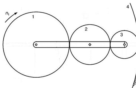
Se a engrenagem 1 está acoplada ao eixo de um motor que rotaciona a 750 rpm no sentido horário, qual a rotação do eixo de saída no braço se a engrenagem 4 é fixa?
