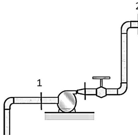
Considerando as perdas de cargas na válvula e conexões em curva igual a 5 m, qual potência deverá ser fornecida à bomba?
