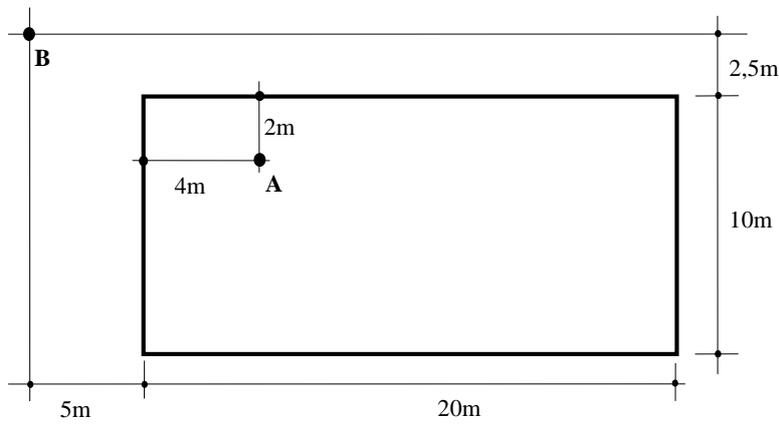
Considerando uma edificação com uma planta retangular de 10 m de largura e 20 m de comprimento, que aplica no terreno uma pressão uniformemente distribuída de 40 kPa, qual alternativa corresponde ao acréscimo de tensão no ponto A, dentro da área carregada, a 4 m de profundidade, e no ponto B, fora da área carregada, a 5 m de profundidade, respectivamente?
