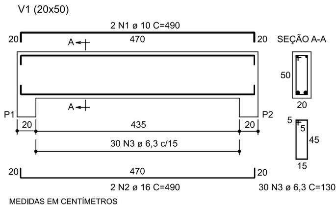
Se a massa nominal por unidade de comprimento da barra de diâmetro  $\varnothing 6,3$  mm for  $0,25$  kg/m, a massa total de estribos, em kg, será
