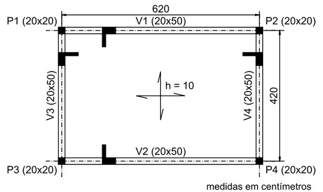
O volume necessário para concretar a laje e as quatro vigas, sem contar os pilares, é
