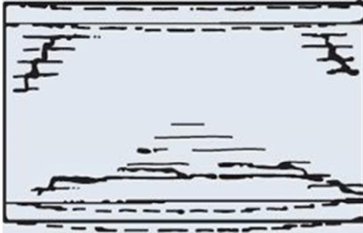
1Estrutura de concreto armado deformada e alvenaria fissurada (Fonte: Thomaz, 1989)
