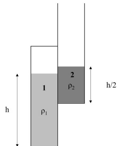
A figura anterior representa dois tanques com forma de prisma quadrangular. No cálculo da pressão que devem suportar os tanques de armazenamento de líquidos, é fundamental a correta estimativa da carga hidrostática.
