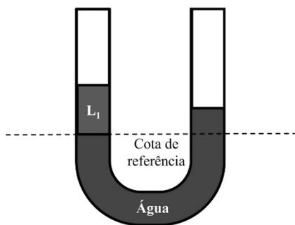
Um sistema de vasos comunicantes usado para medir a densidade de um líquido  $L_1$  imiscível na água, que possui densidade igual a  $1.000 \text{ kg/m}^3$ , é apresentado na figura precedente. Sabe-se que a altura do líquido  $L_1$  desde a cota de referência é o dobro da altura da água desde a cota de referência.
