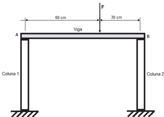
As colunas 1 e 2 são idênticas, isto é, mesmo material, mesmo comprimento e mesma seção transversal, e a viga é simplesmente apoiada sobre as colunas.
